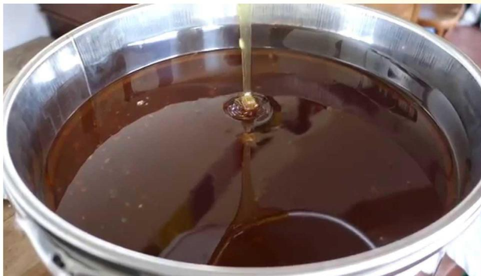
Le maturateur est surtout un décanteur qui permet aux impuretés de remonter à la surface sous forme d'une fine mousse. 2-3 jours suffisent pour décanter.
