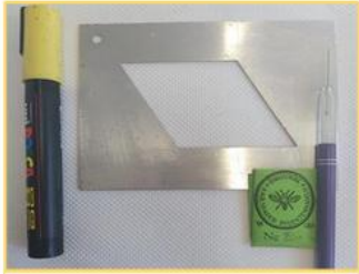
Marqueur, aiguille entomologique No.2 (0,45 mm), gabarit (10 x 10 cellules)
